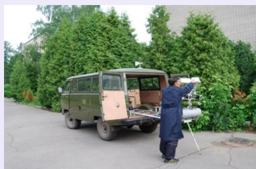
Рис.5.2. Мобильный пробоотборный комплекс МПКГ-1 ФГУП «НИИ НПО «ЛУЧ»
