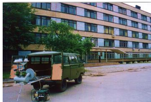
Рис.5.2. Мобильный пробоотборный комплекс МПКТ-1 АО «НИИ НПО «ЛУЧ»
