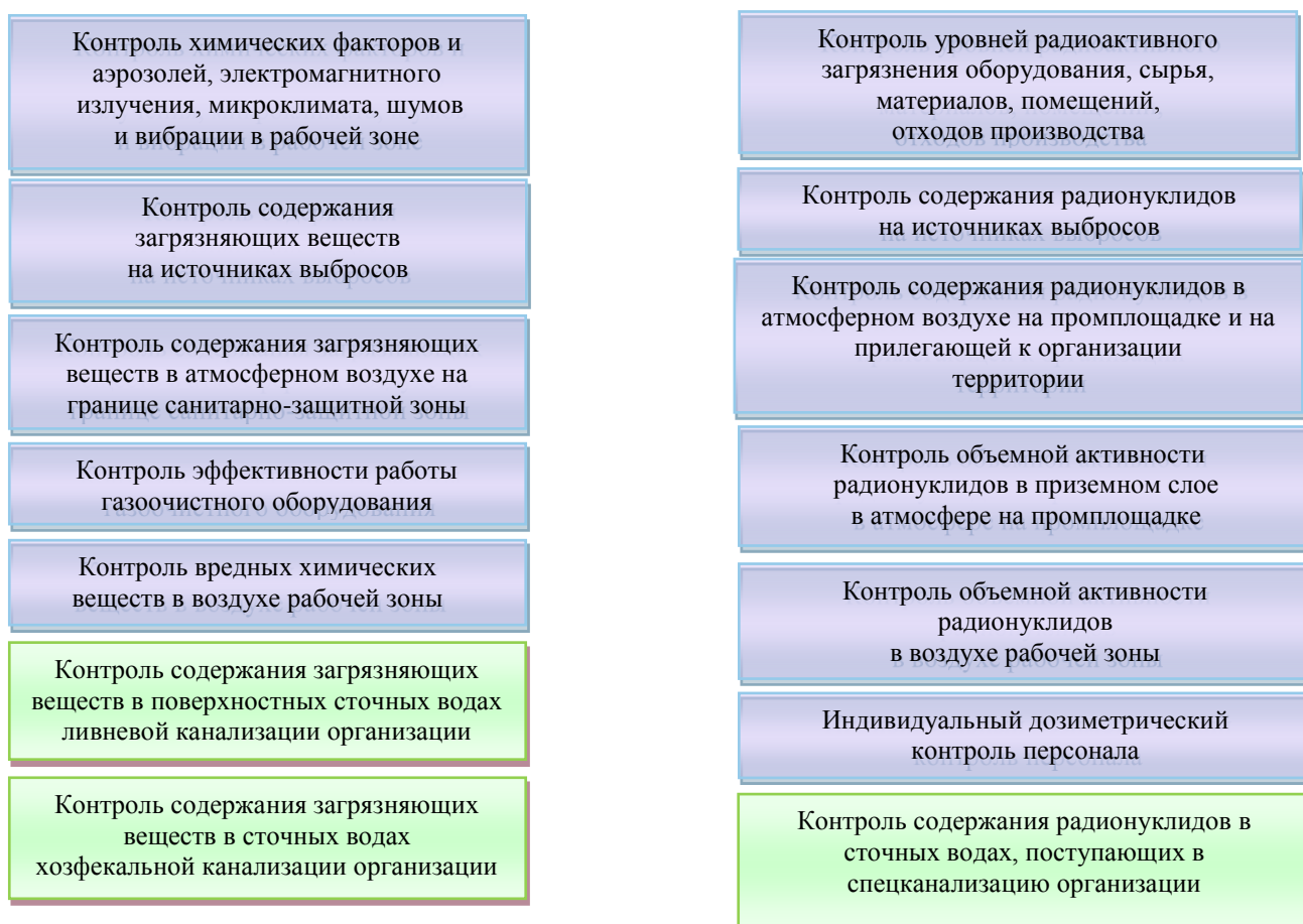
Рис.5.4. Структура производственного экологического контроля в организации
